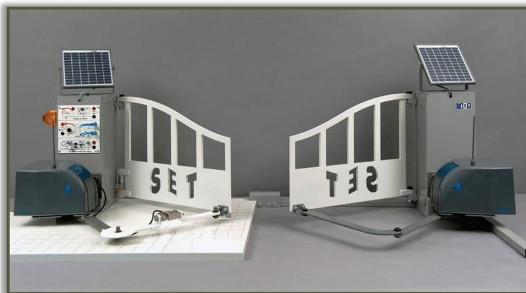
Ce système est un produit innovant, développé par la société Avidsen, destiné à la commande de portails à battants. Ce produit se caractérise par une absence de liaison au réseau électrique basse tension grâce à son alimentation par panneaux photovoltaïques ainsi que par une absence de liaison filaire entre les deux centrales électroniques grâce à la radio-transmission.
